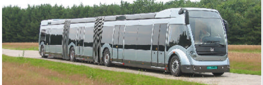
欧洲最现代、面向未来的巴士快速交通车型：斐利亚。它是 VDL 集团属下先进巴士快速交通公司 (APTS) 所设计制造的，车长 24 米，已有 12 辆在荷兰城市投入运营
